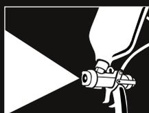
Aplicar corever con equipo de alta presión, en varias capas de forma circular y sin saturar
