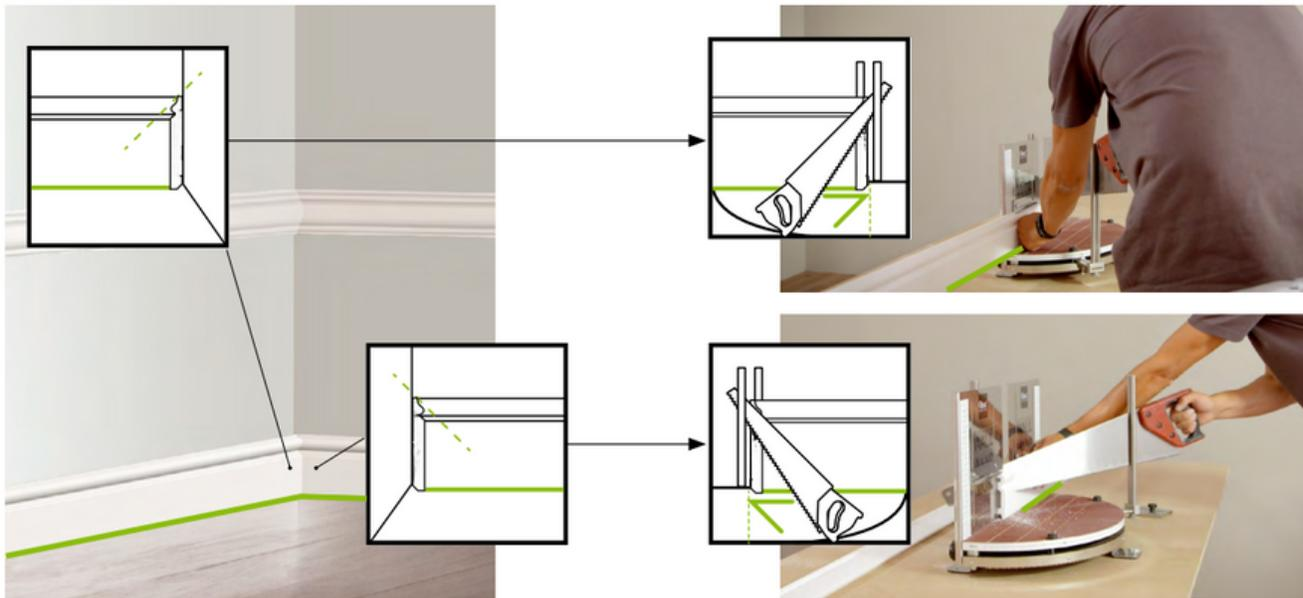
“Para realizar cualquier corte a nuestras zoclos, recomendamos el uso de sierra ingleteadora con disco para cortar aluminio de 80 dientes ó segueta de diente fino”
